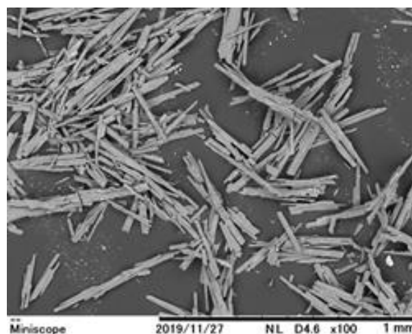
図7 塩化ナトリウムを添加した反応液を用いた実験により得られた沈殿物のSEM画像
