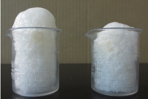
図4 通常のデンプン発泡体（サンプルE，左）と条件Hで作製したCNF含有デンプン発泡体（右）の比較
