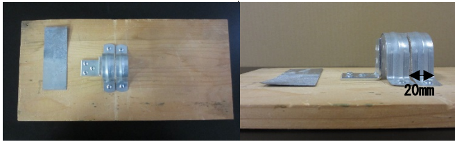
図8 カット長を20 mmに設定した自作の切断用器具
