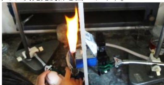
図1. DVD分光器を用いた簡易型炎光光度計
