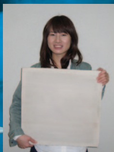
▲ガラスピンから作成した ガラス発砲体
