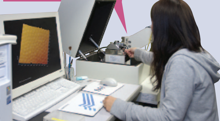
◀フィルム表面の凹凸を計る原子間力顕微鏡(AFM)
