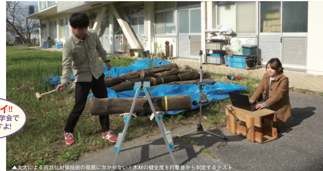
▲丸太による液状化対策技術の発展に欠かせない!木材の健全度を打撃音から判定するテスト
